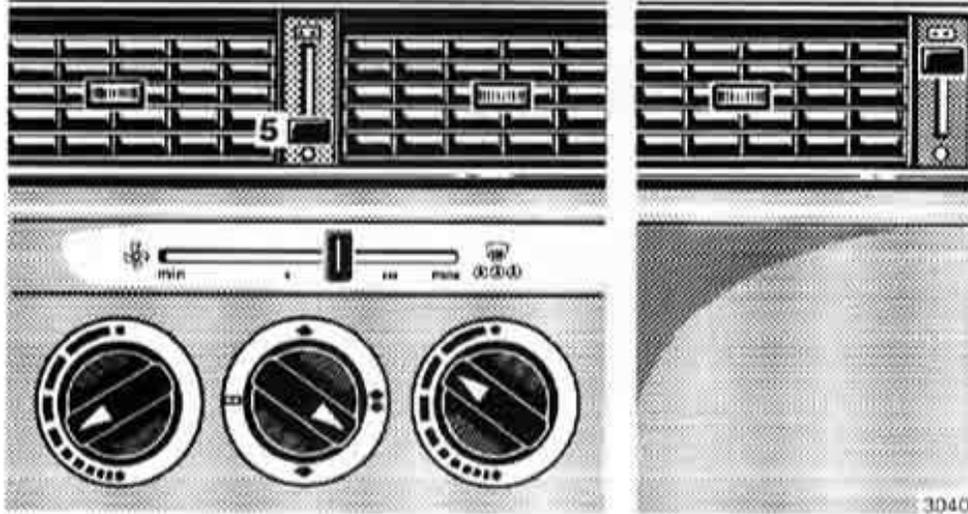
Aire calentado a diferentes temperaturas para los lados izquierdo y derecho y cantidad media de aire hacia el parabrisas y hacia el espacio inferior. Poner la palanca (5) en el tope inferior.
