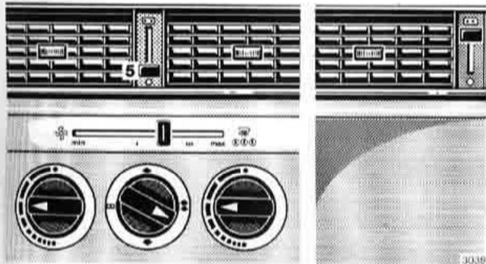
Aire calentado y cantidad media de aire hacia el parabrisas y hacia el espacio inferior. Poner la palanca (5) en el tope inferior.
