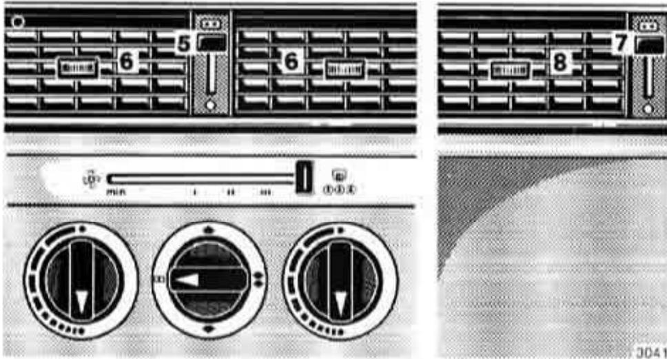
Cantidad máxima de aire sin calentar, sólo por las entradas orientables (6 y 8). Para ello, poner las palancas (5 y 7) en el tope superior.
