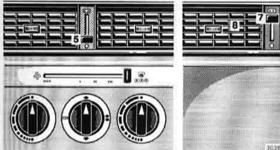
Cantidad máxima de aire calentado al máximo, hacia el parabrisas. Para deshelar los cristales laterales, desplazar las palancas (7) de ventilación lateral hacia arriba y orientar las entradas de aire (8) hacia los cristales laterales. Poner la palanca (5) en el tope inferior.
