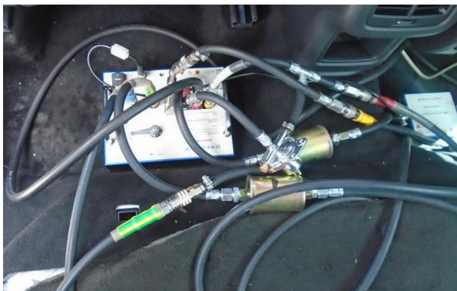
Instalación de flujómetro en líneas de combustible
