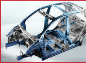
Estructura reforzada en un 44% con aceros avanzados de ultra alta resistencia
